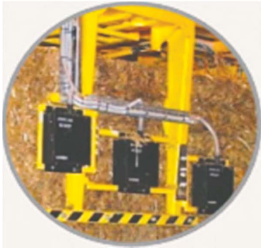
3-spots målinger monteret i griber på kran
